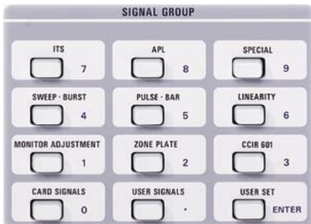
Über die Frontplatte lassen sich 12 verschiedene Signalgruppen aufrufen
